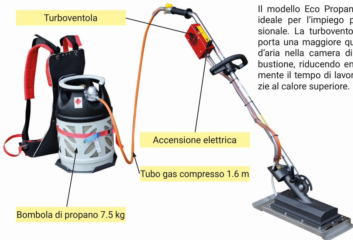
Il modello Eco Propan P2 è ideale per l'impiego professionale. La turboventola apporta una maggiore quantità d'aria nella camera di combustione, riducendo enormemente il tempo di lavoro grazie al calore superiore.
