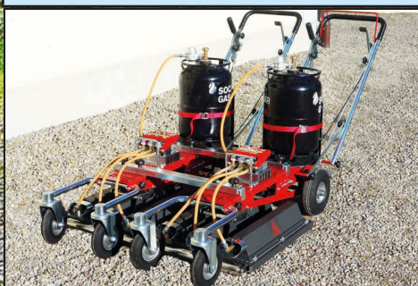
Sada přípojení spojení 2 strojů Master, pracovní šířka 102 cm
