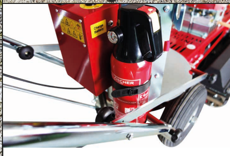
Fire extinguisher včetně držáku včetně 1 kg prášku ABC
